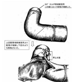
図3 破断箇所詳細
